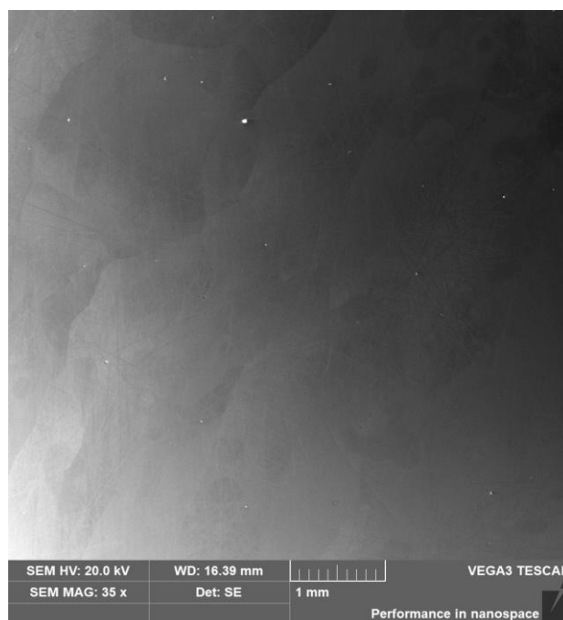
Obr. 24: FA-5Si , TZ při 900 °C/100 h, SE, 35x
