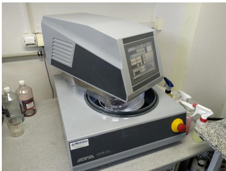
Obr. 13: Metalografická bruska Saphir 550
