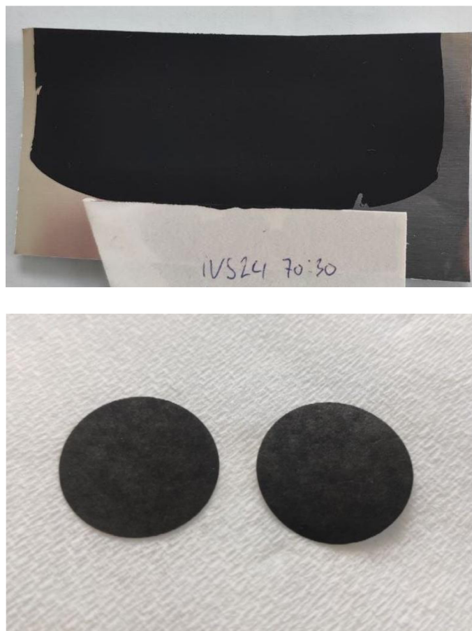
Obrázek 8.1 Nanesená a vysušená elektrodová pasta na hliníkovém kolektoru a vyrobené elektrody s průměrem 18 mm
