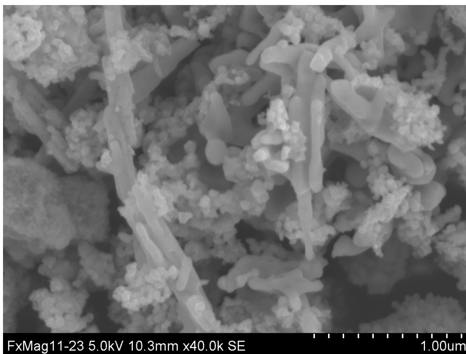
Obr. 54: SEM snímek demonstrující směs \text{Fe}_2(\text{ox})_3 \cdot 4\text{H}_2\text{O} (tyčinky) a magnetitu v poměru látkových množství 1:1.
