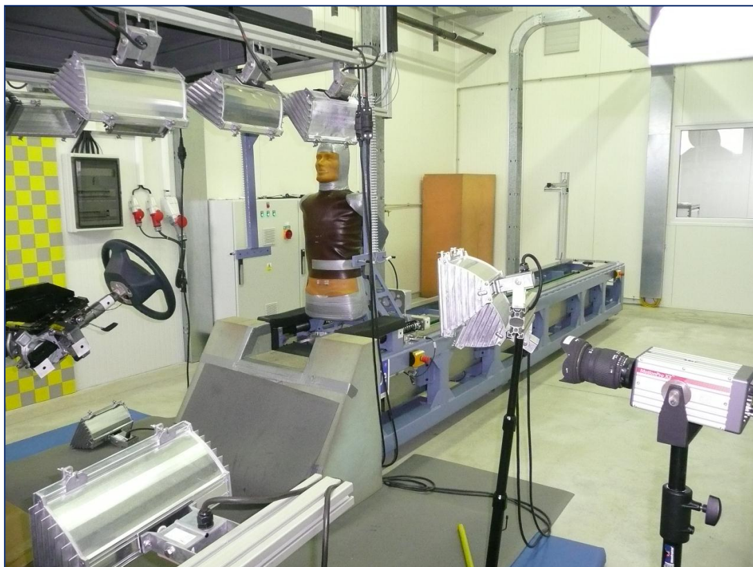
Obr. 1.4. Testovací linka pro Body Block test [5]
