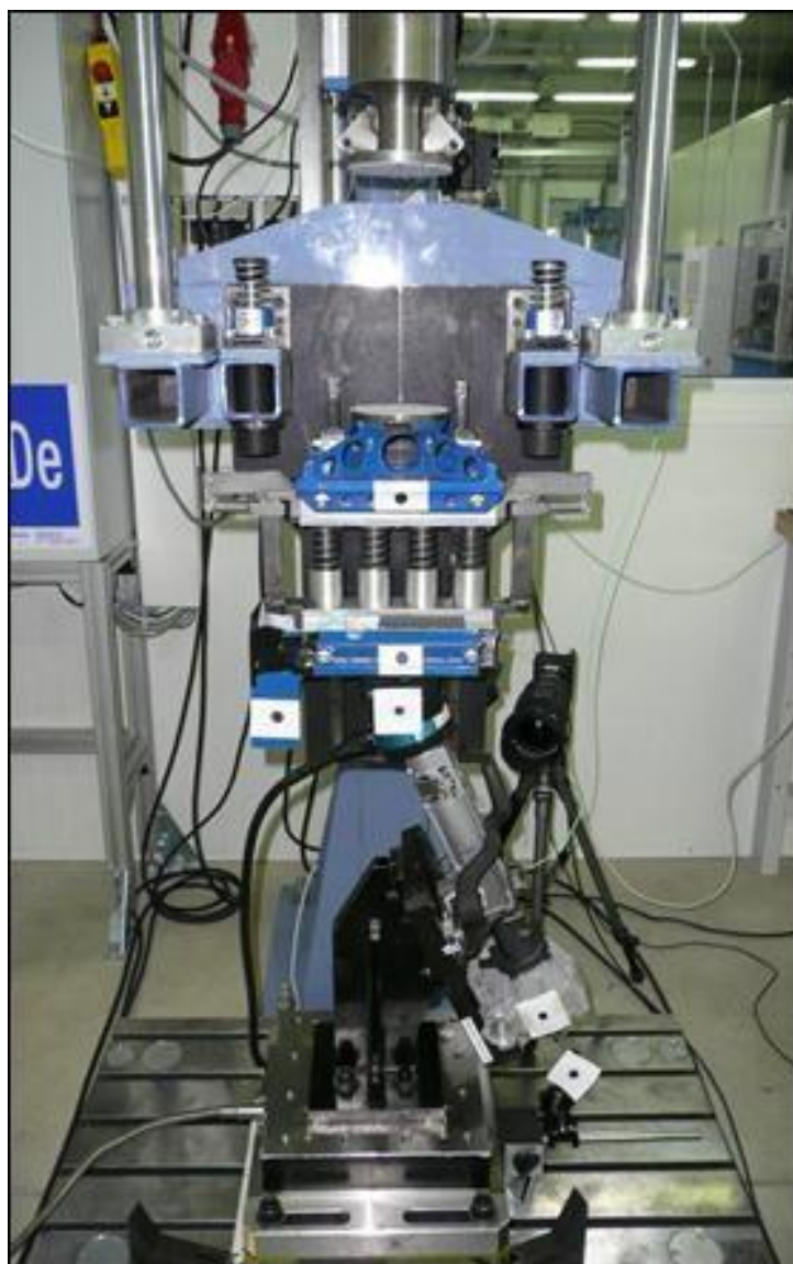
Obr. 1.5. Testovací stroj Drop Tower Rig pro Drop mass test [5]
