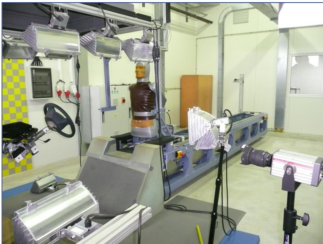
Obr. 1.4. Testovací linka pro Body Block test [5]
