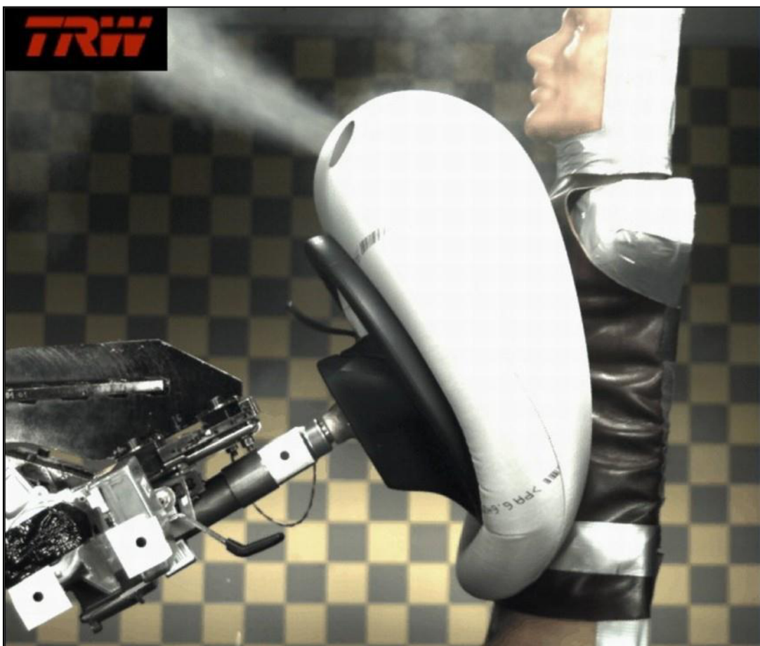
Obr. 2.11. Aktivace airbagu v ostrém testu [5]
