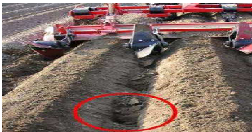
Obrázek 4 – Zařízení na důlkování brambor s detailem důlku v meziřadí brambor (VÚMOP, 2022)
