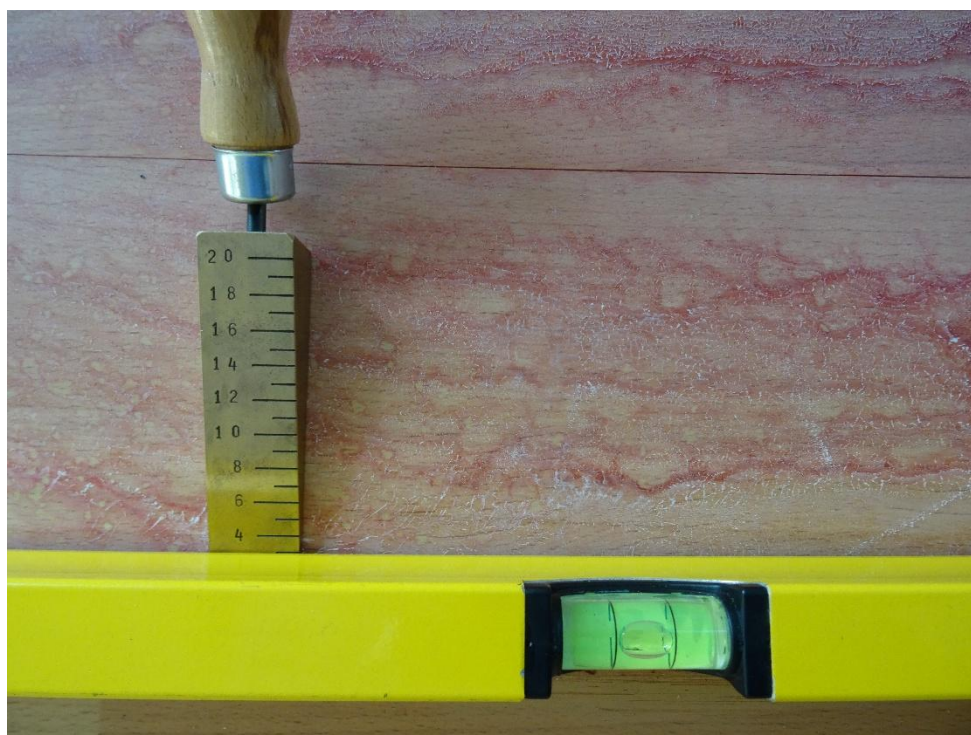
Obrázek 48 – Maximální podélné prohnutí vzorku C
