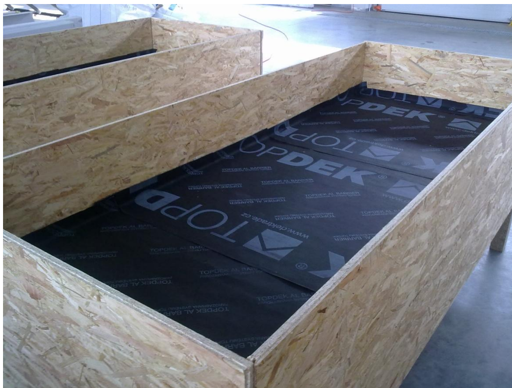
Obrázek 19 – Konstrukce OSB vany pro umístění zkoušených podlah
