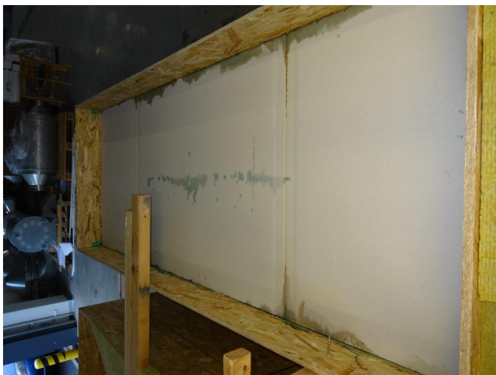
Obrázek 53 – Sádroláknité desky smáčené vodou, která pronikla mezerami v mirelonu
