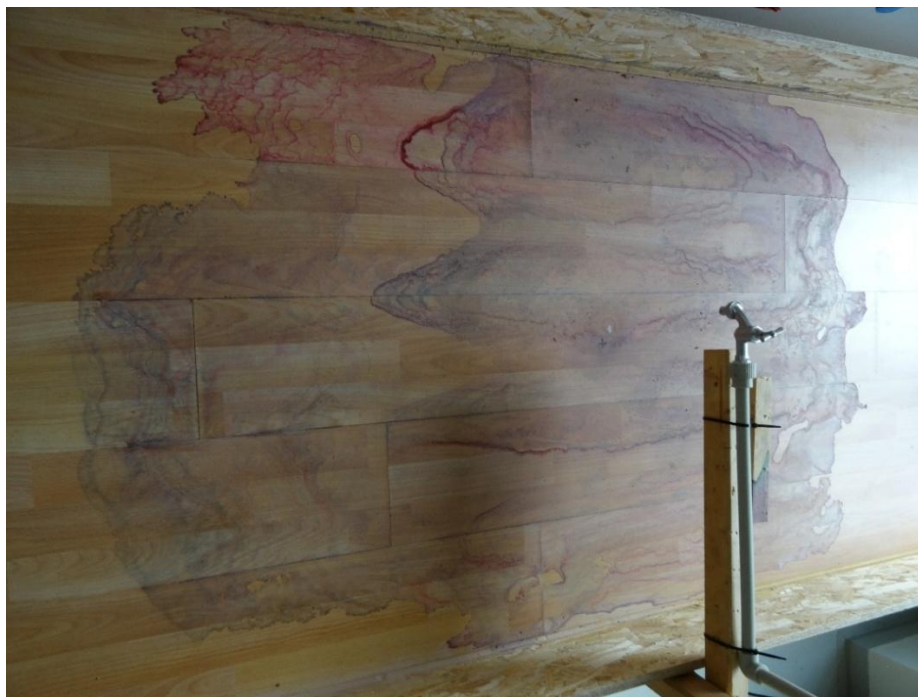
Obrázek 40 – Rozsah smáčení podlahy B po první fázi namáhání
