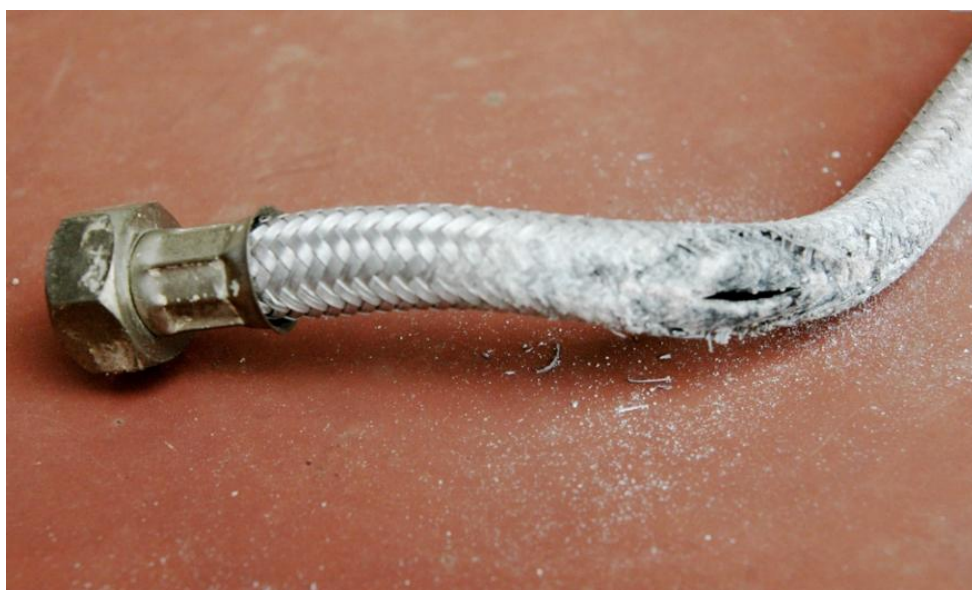
Obrázek 17 – Porušené hliníkové opletení hadice [13]
