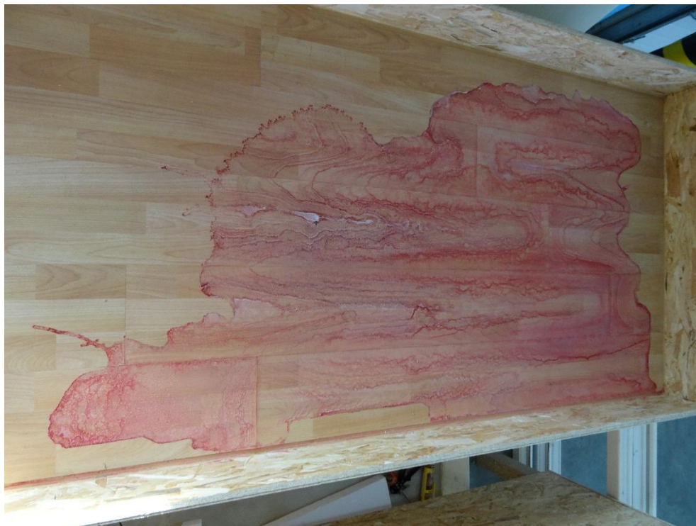
Obrázek 46 – Rozsah smáčení podlahy C po první fázi namáhání
