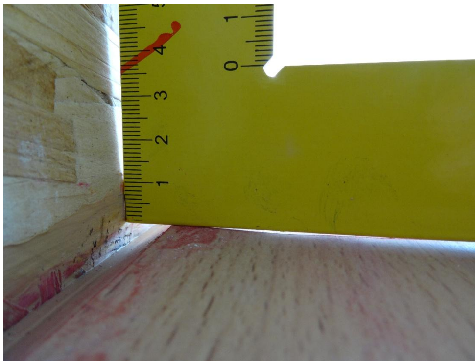
Obrázek 49 – Deformace na kraji vzorku podlahy C
