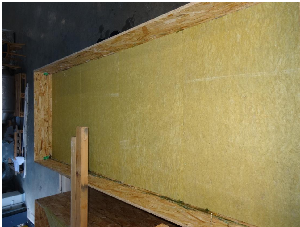
Obrázek 54 – Minerální vata smáčená pouze vodou stékající po stěnách OSB vany
