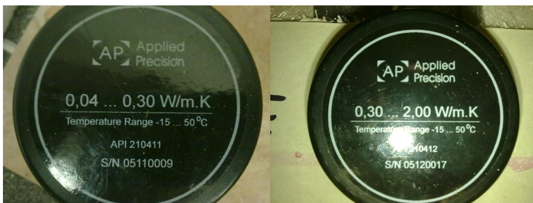
Obrázek 61 – Použité příložené sondy přístroje ISOMET 2104
