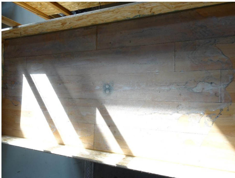
Obrázek 37 – Rozsah smáčení podlahy A po první fázi namáhání
