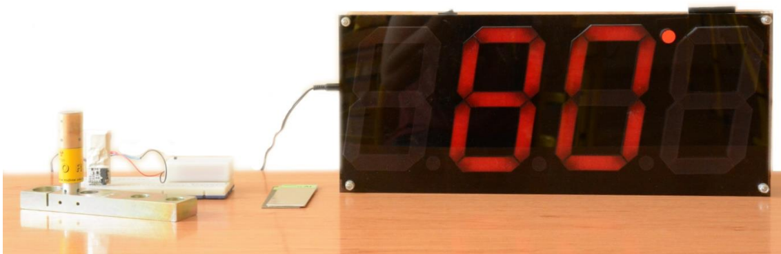
Obrázek 19: Sestava pro měření koeficientu absorpce
