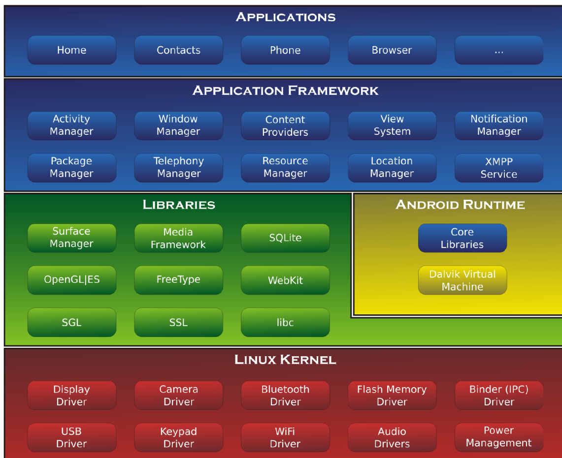
Obrázek 3.3: Schéma architektury operačního systému Android. Architekturu operačního systému Android lze rozdělit do pěti sekcí – linuxové jádro, knihovny, Android Runtime, aplikační framework a samotné aplikace.
