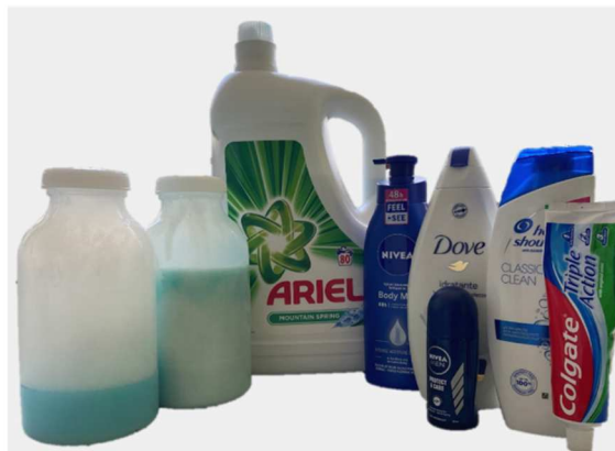
Obr. 6.3: (Zprava) Produkty osobní hygieny, prací prostředek a výsledná směs pro přípravu syntetické šedé vody ( Radim Hladký, 2022 )
