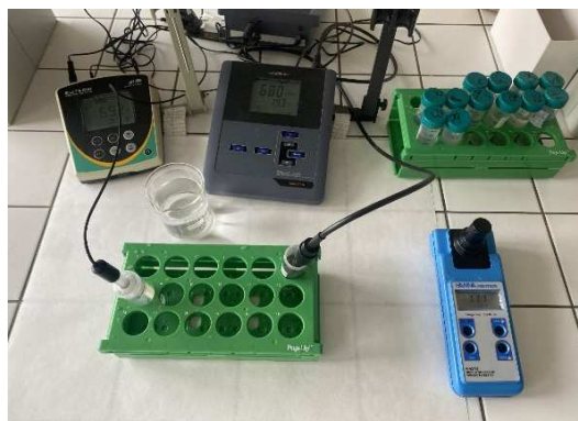
Obr. 6.12: Měření (zleva) pH, konduktivity a zákalu ( Radim Hladký, 2022 )
