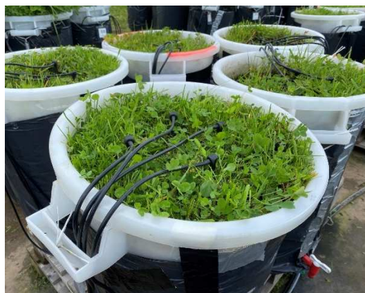
Obr. 6.7: Rozmístění rozstříkovačů ve filtru (Radim Hladký, 2022)
