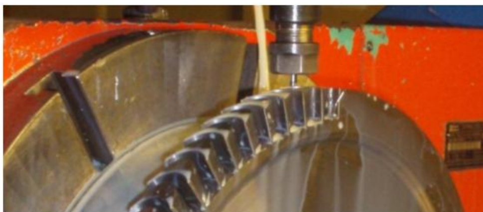
Obr. 4.3: Obrábění lopatek oběžného kola [20]
