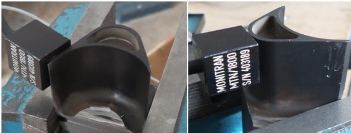
Obr. 6.5: Upnutí lopatky ve svěráku a připevnění akcelerometru
