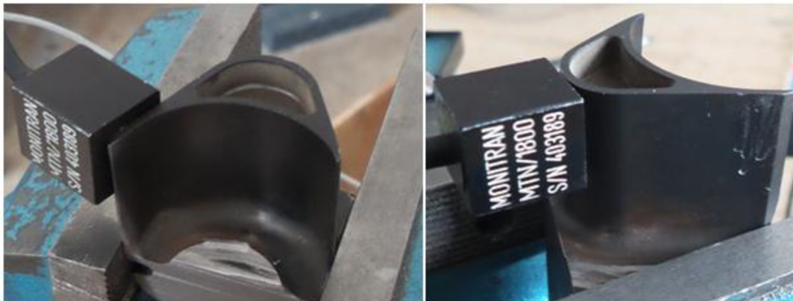
Obr. 6.5: Upnutí lopatky ve svěráku a připevnění akcelerometru
