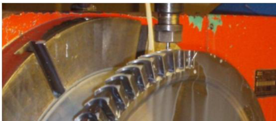
Obr. 4.3: Obrábění lopatek oběžného kola [20]
