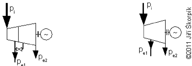
Obr. 7 Schéma turbín s jedním regulovaným odběrem (vlevo) a s jedním neregulovaným odběrem (vpravo)
