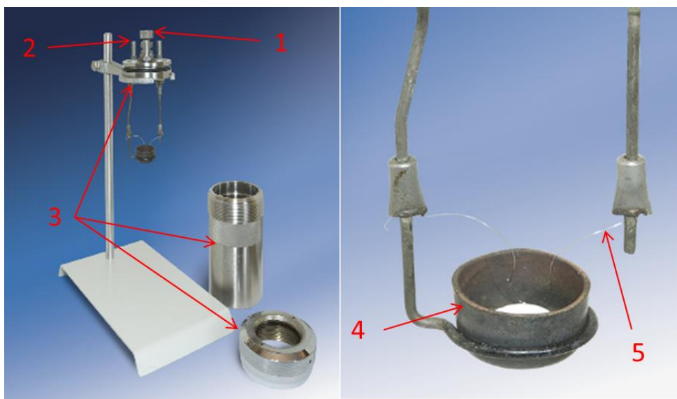
Obrázek 14: Rozebnaná kalorimetrická bomba; 1 - tlakový ventil pro vypouštění zplodin hoření, 2 - přípojky pro zapalovací přívody, 3 – rozebnaná kalorimetrická bomba, 4 - kelímek na vzorek paliva, 5 - odporový drátek [2]
