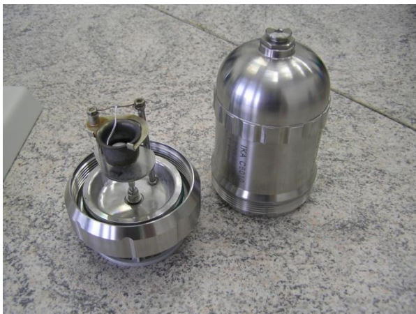
Obrázek 3: Ukázka jednotlivých částí kalorimetrické bomby kalorimetru IKA C 6000 global standards
