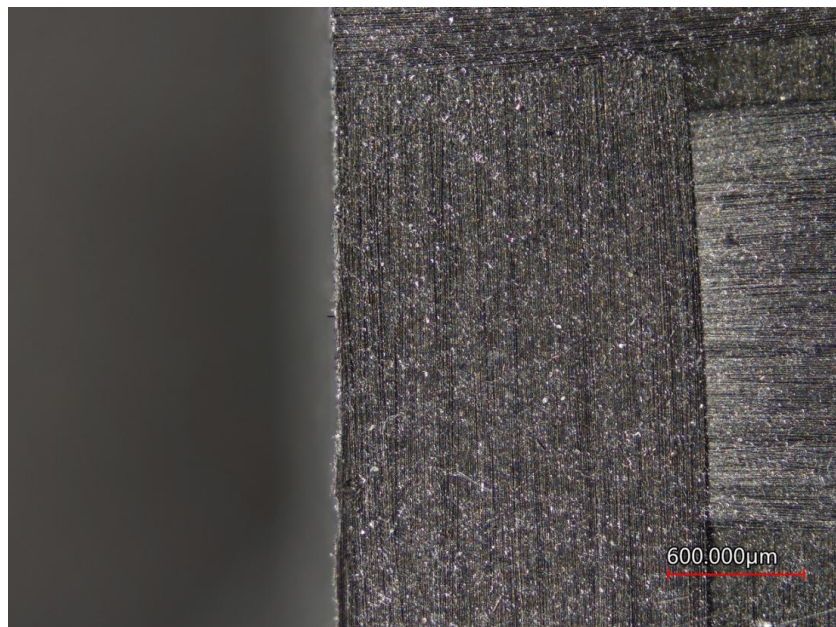
Obr. 46: Vzorek frézovaný řezným nástrojem WINSTAR
