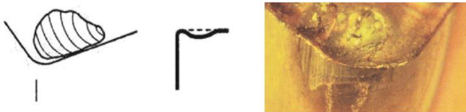
Obr. 10: Opotřebení ve tvaru žlábků [11]
