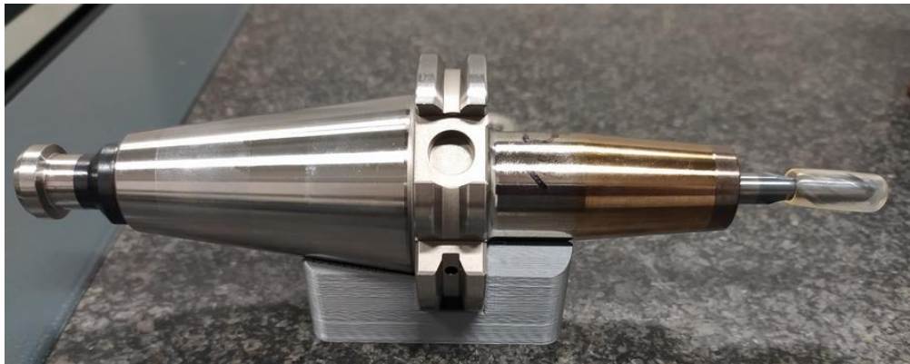
Obr. 30: Nástroj s upínačem ustavený v přípravku
