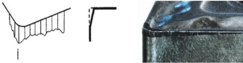
Obr. 9: Opotřebení na hřbetu [11]
