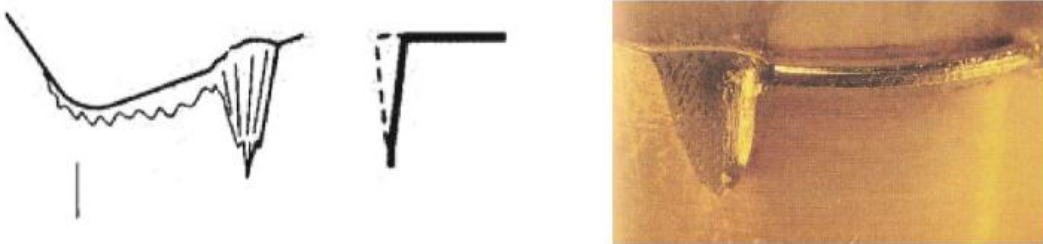
Obr. 12: Opotřebení ve tvaru vrubu [11]
