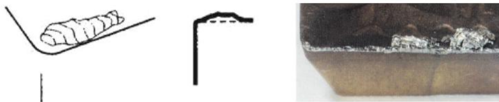
Obr. 11: Vytváření nárůstku na břitu [11]
