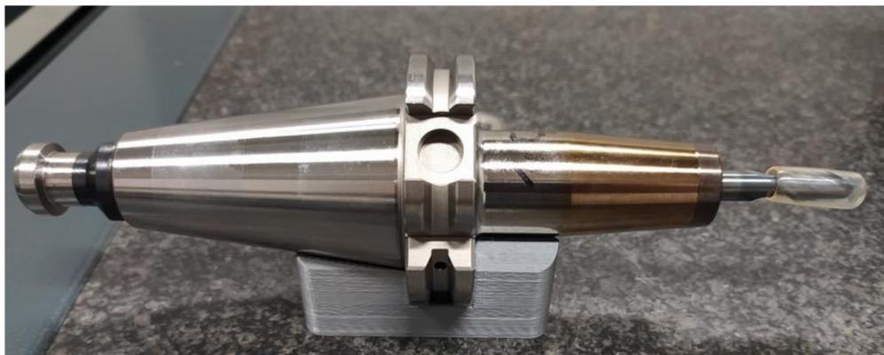
Obr. 30: Nástroj s upínačem ustavený v přípravku
