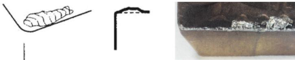
Obr. 11: Vytváření nárůstku na břitu [11]
