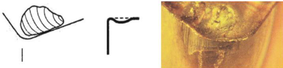
Obr. 10: Opotřebení ve tvaru žlábků [11]
