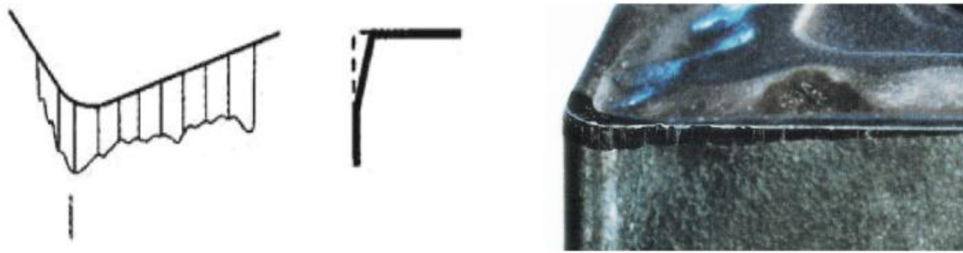
Obr. 9: Opotřebení na hřbetu [11]
