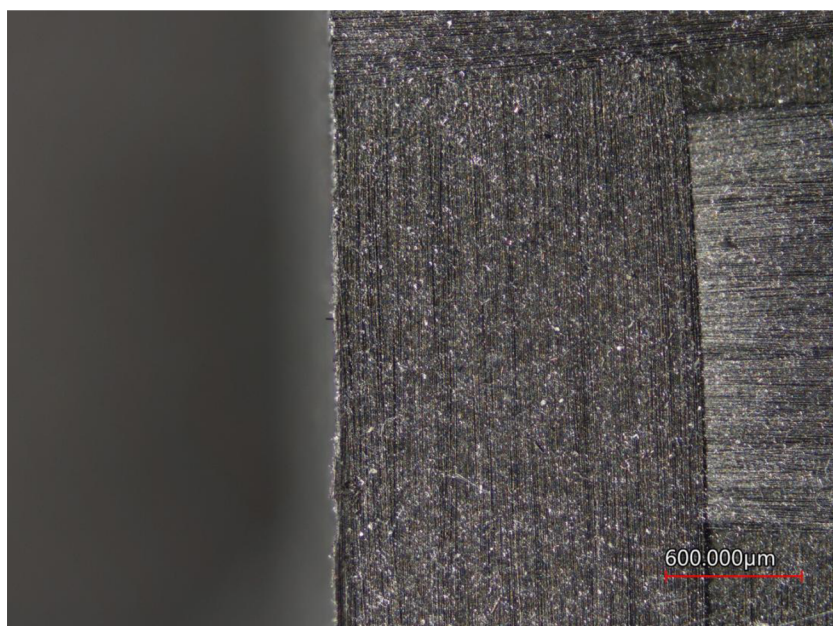
Obr. 46: Vzorek frézovaný řezným nástrojem WINSTAR
