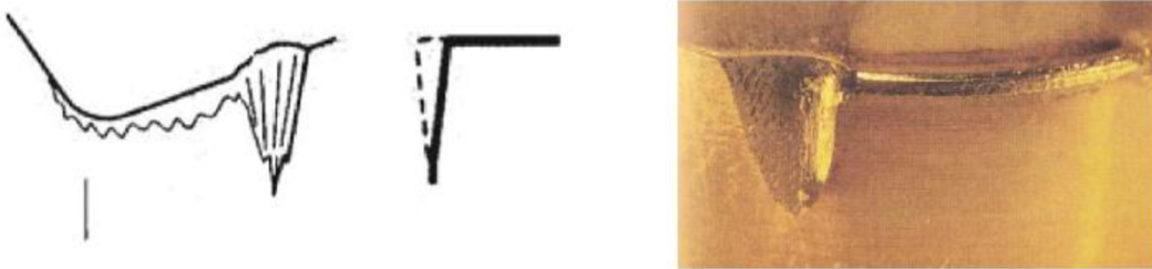
Obr. 12: Opotřebení ve tvaru vrubu [11]
