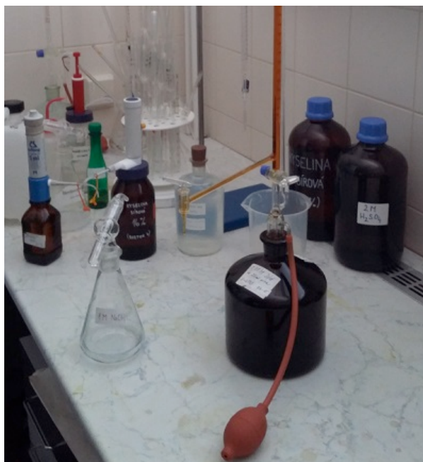
Obrázok 24 Titrovacia sústava a roztok na stanovenie SO_2 (Zdroj: vlastný)
