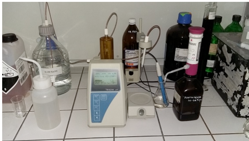
Obrázok 23 Magnetická miešačka s elektródou na meranie pH (Zdroj: vlastný)
