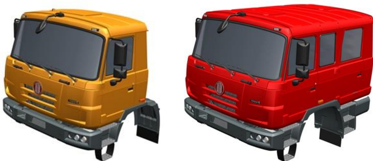
Obr. 4. Dvoudveřová a čtyřdveřová kabina vozidla TATRA PHOENIX. [3]
