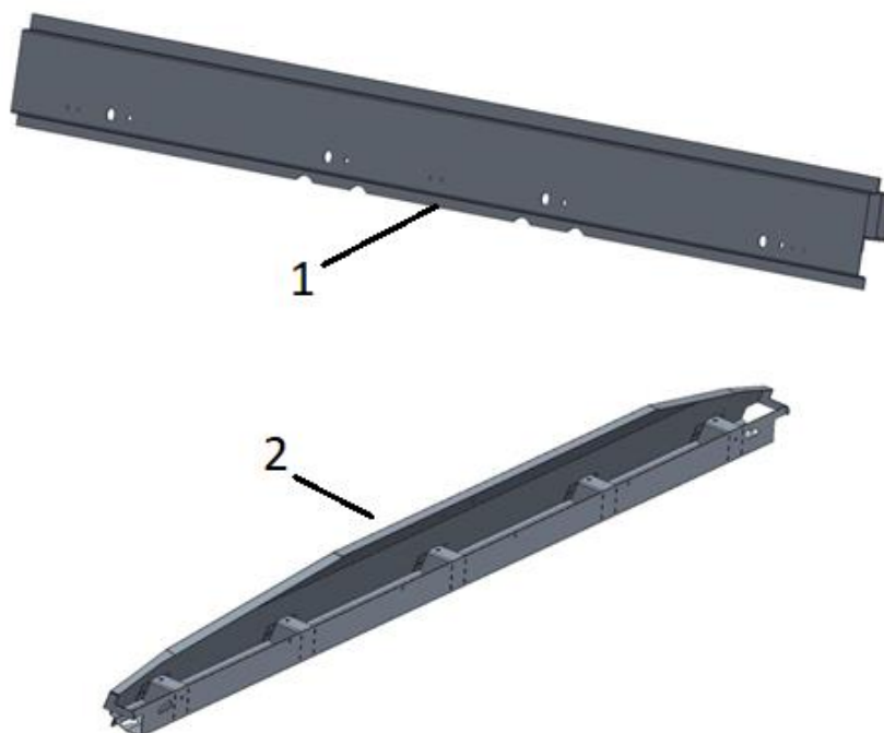
Obr.14. CAD model podsestav podokenního příčnicku nahoře a nadokenního příčnicku dole.
