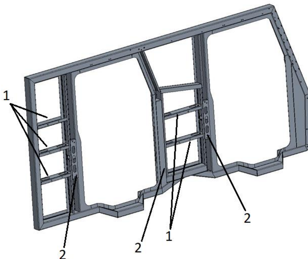
Obr. 12. CAD model vnitřní části bočnice.
