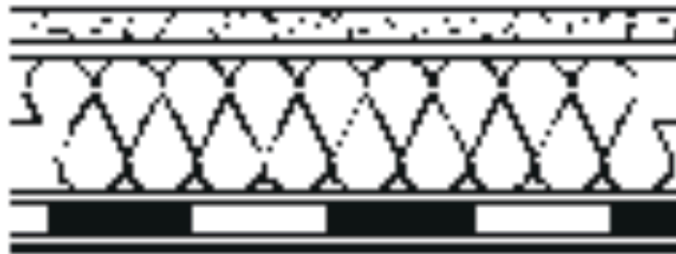
Obr. 12 Schéma střechy s opačným pořadím vrstev [14]
