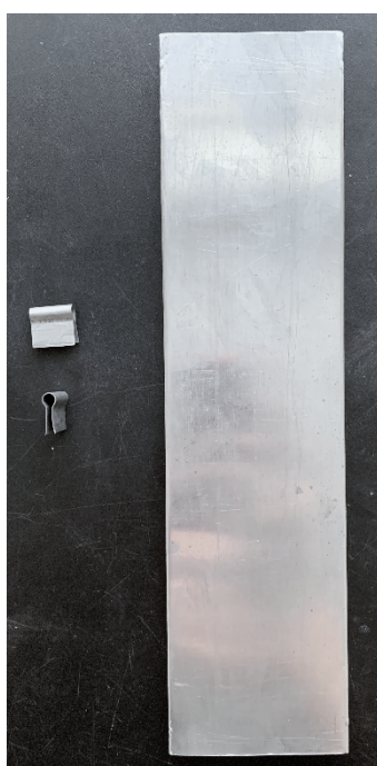
Obr. 20 Vlevo upravený nosič vzorku s příponkou; vpravo vzorky připravené k umístění do komory
