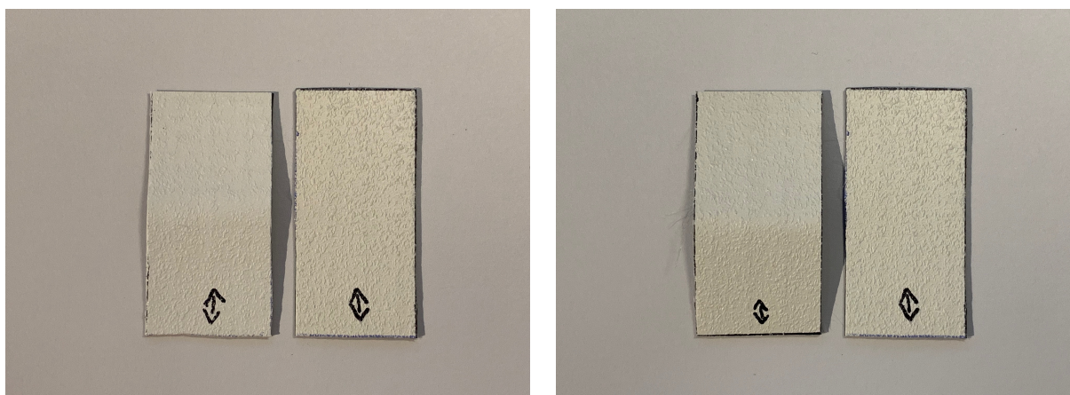
Obr. 36 Vlevo referenční vzorek; vpravo vzorek vystavený expozici 2500 hodin
