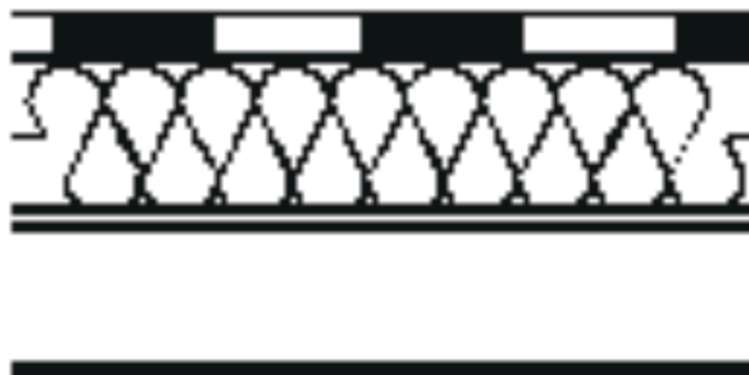
Obr. 11 Schéma střechy s klasickým pořadím vrstev [14]
