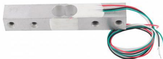
Obr. 12 - Snímač hmotnosti YZC - 131 [7]
