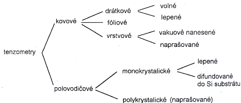
Obr. 2 - Rozdělení tenzometrů dle vlastností [1]
