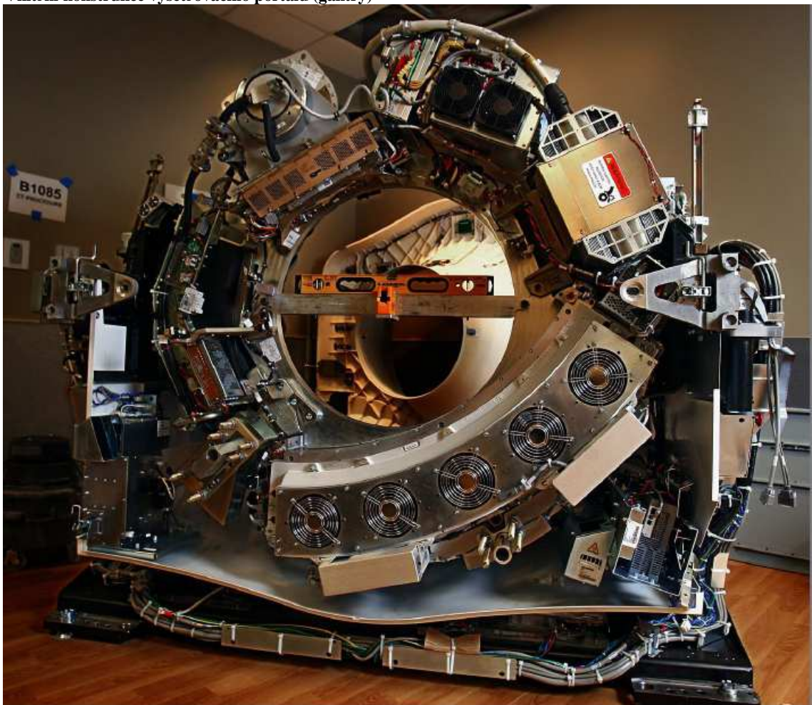
Vnitřní konstrukce vyšetřovacího portálu (gantry)
