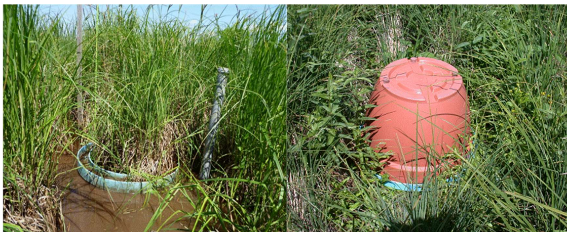
Obrázek 7: Plastový límec (A) a instalace odnímatelné emisní komory (B) (foto H. Čížková)
