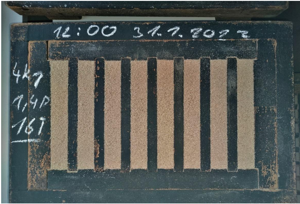
Obr. 29 Dřevěný jaderník s vytvrzenými trámečky
