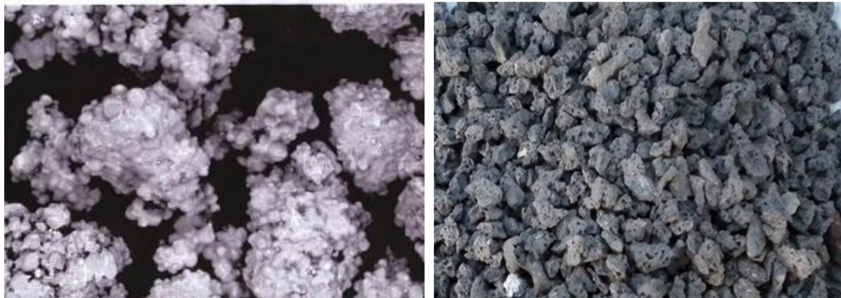
Obr. 6 Tvar a povrch magnesitového ostřiva [5; 9]
