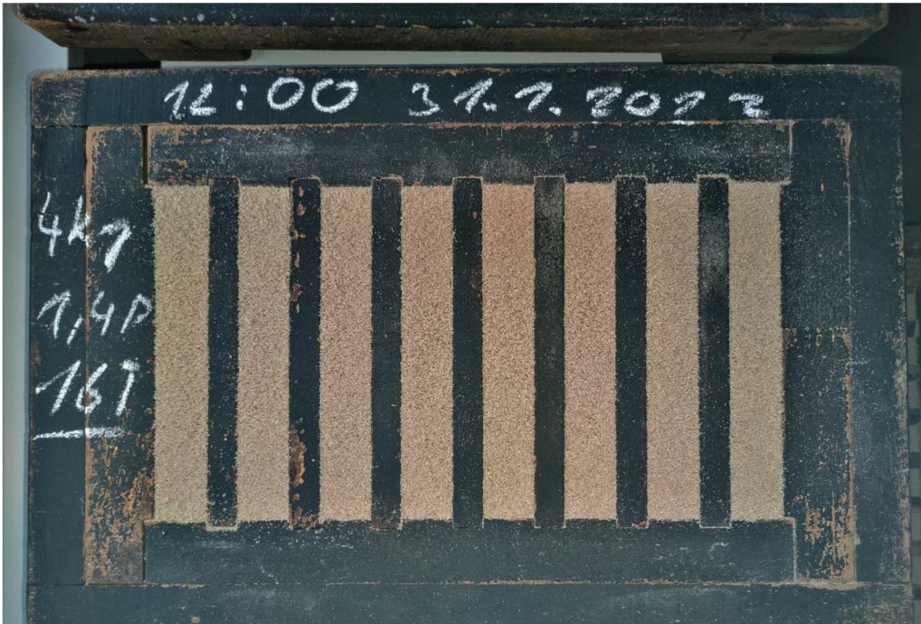
Obr. 29 Dřevěný jaderník s vytvrzenými trámečky
