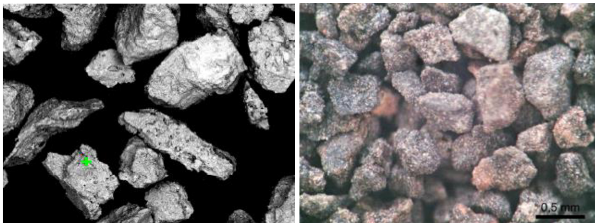
Obr. 8 Tvar a povrch dunitu (Magnolit)
