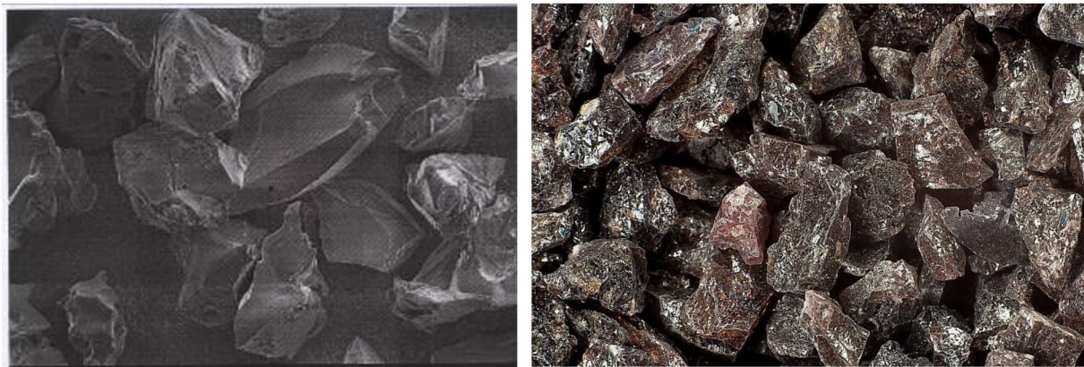
Obr. 4 Tvar a povrch elektrokorundu [5; 8]
