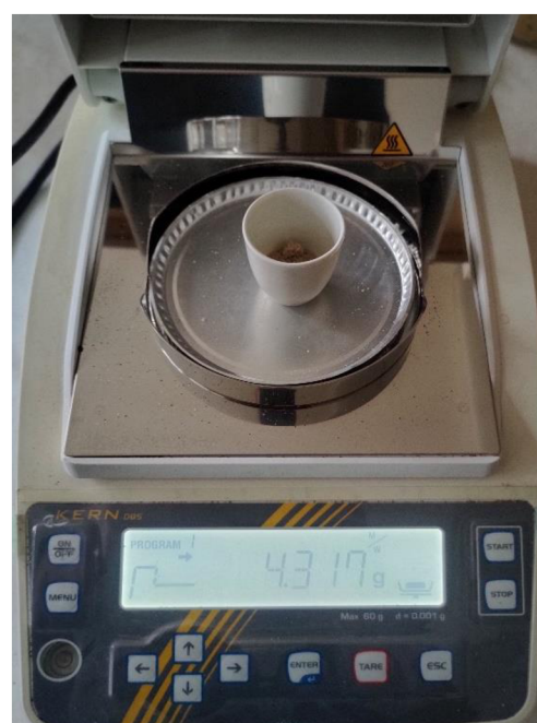
Obr. 26 Vzorek formovací směsi v žihacím kelímku
