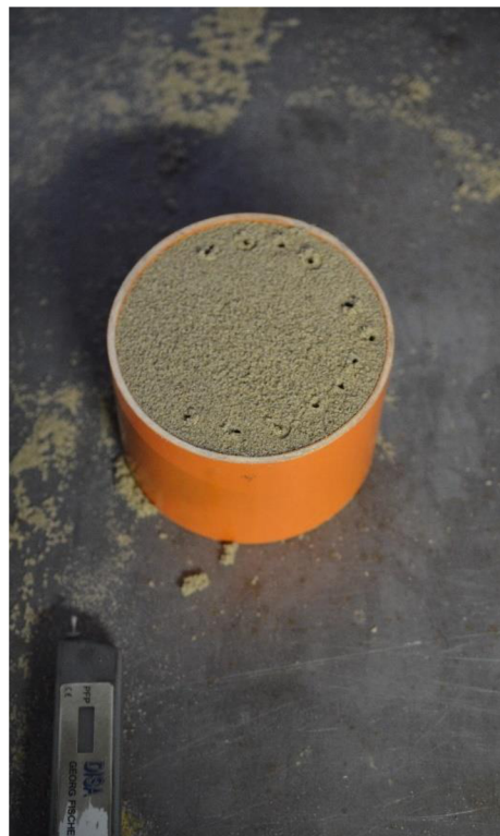
Obr. 44 Zkušební váleček pro měření zpracovatelnosti.
