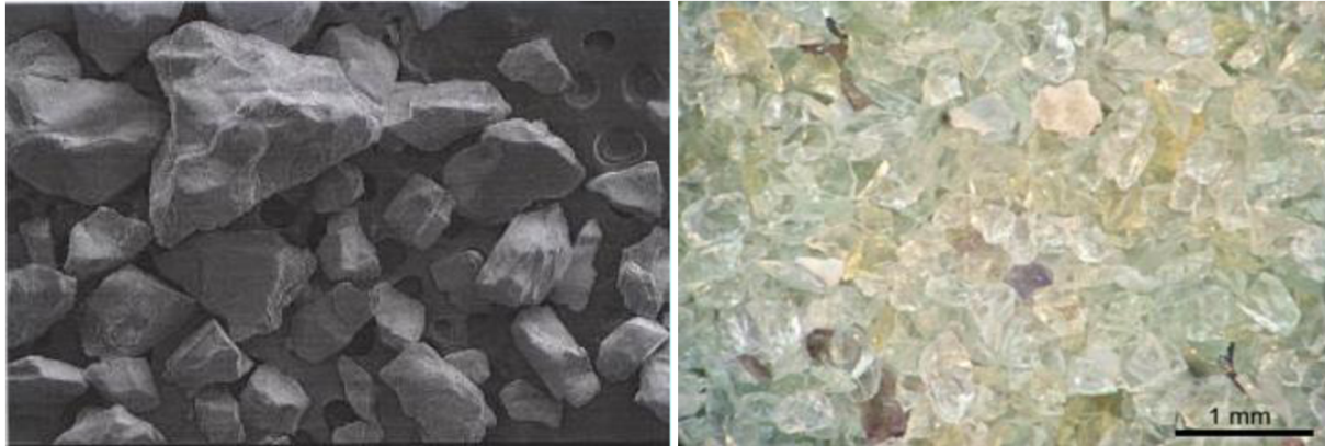
Obr. 3 Tvar a povrch olivínu [5; 7]
