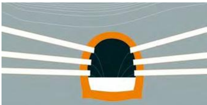
Obr. 5.5 [2.21] Schématický řez odvodnění oblasti sesuvu s využitím štoly se záústěnými drenážními vrty.
