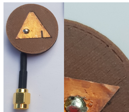
(b) Anténa s detailným pohľadom na vzniknuté dierky.
