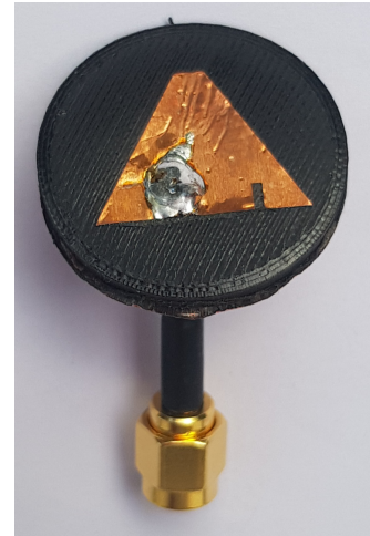
(b) Napájanie veľmi krátkym SMA koax. káblom.
