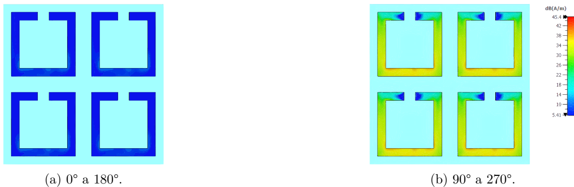
Obr. 2.8: Rozloženie prúdu na moduloch FSS.
