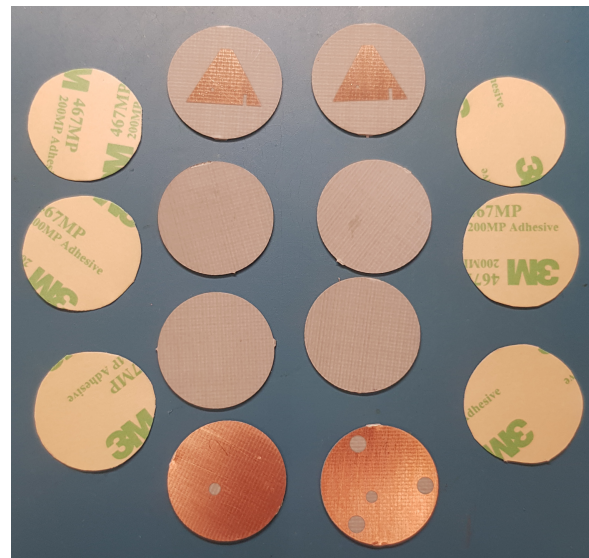
(b) Lepenie štyroch kusov materiálu obojstrannou fóliou 3M.
