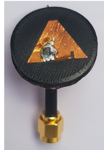
(b) Napájanie veľmi krátkym SMA koax. káblom.
