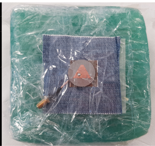
(c) Anténa s FSS umiestnená na fantóme.
