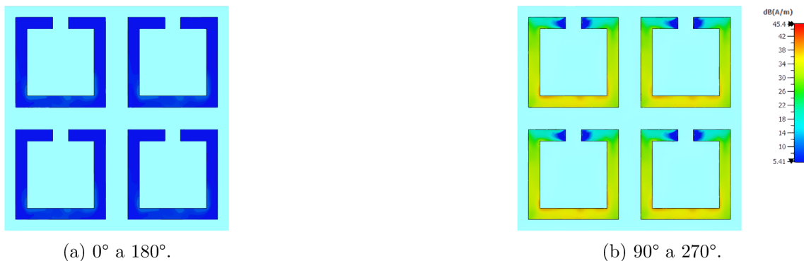
Obr. 2.8: Rozloženie prúdu na moduloch FSS.
