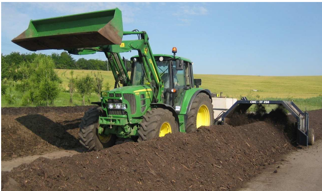
Příloha 7: Překopávač kompostu SANDBERGER CMC-ST-250 (autor: Lánský TSMS)
