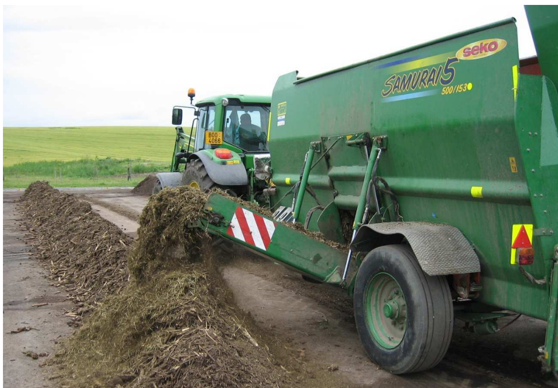
Příloha 6: Pojízdný drtící a míchací vůz SEKO Samurai 5 (autor: Lánský TSMS)
