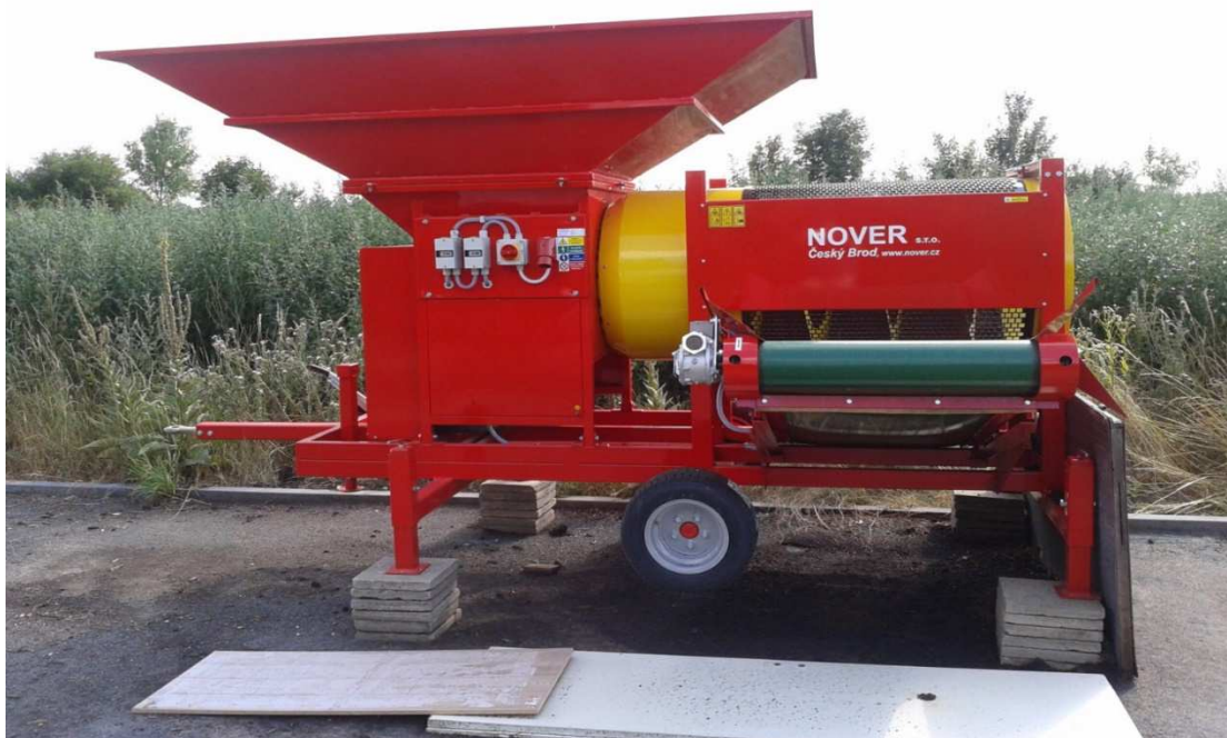
Příloha 10: Bubnový prosévací třídič NOVER (foto autor)
