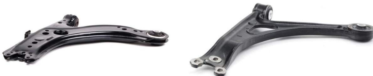
Obr. 23 Porovnání spodních předních ramen (vlevo Škoda Octavia vs. Audi TT vpravo) [27]
