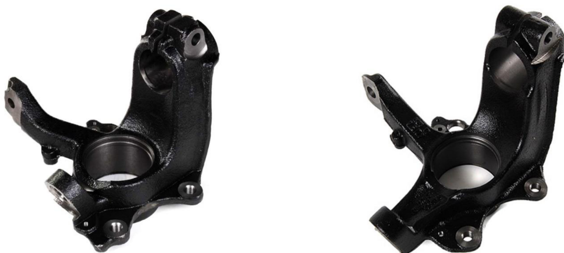
Obr. 22 Porovnání těhlic (vlevo Škoda Octavia vs. Audi TT vpravo) [27]
