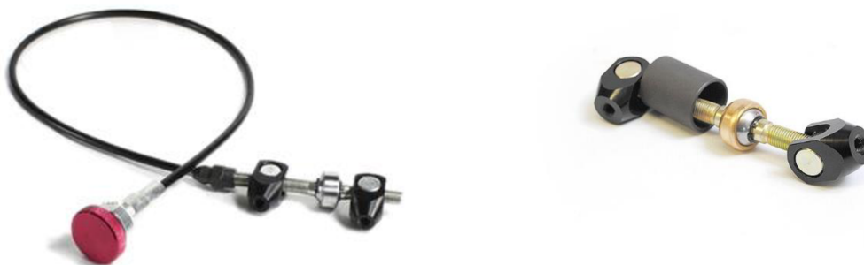
Obr. 10 Vahadlo s možností nastavení za jízdy (vlevo) bez možnosti nastavení za jízdy (vpravo) [12] [13]
