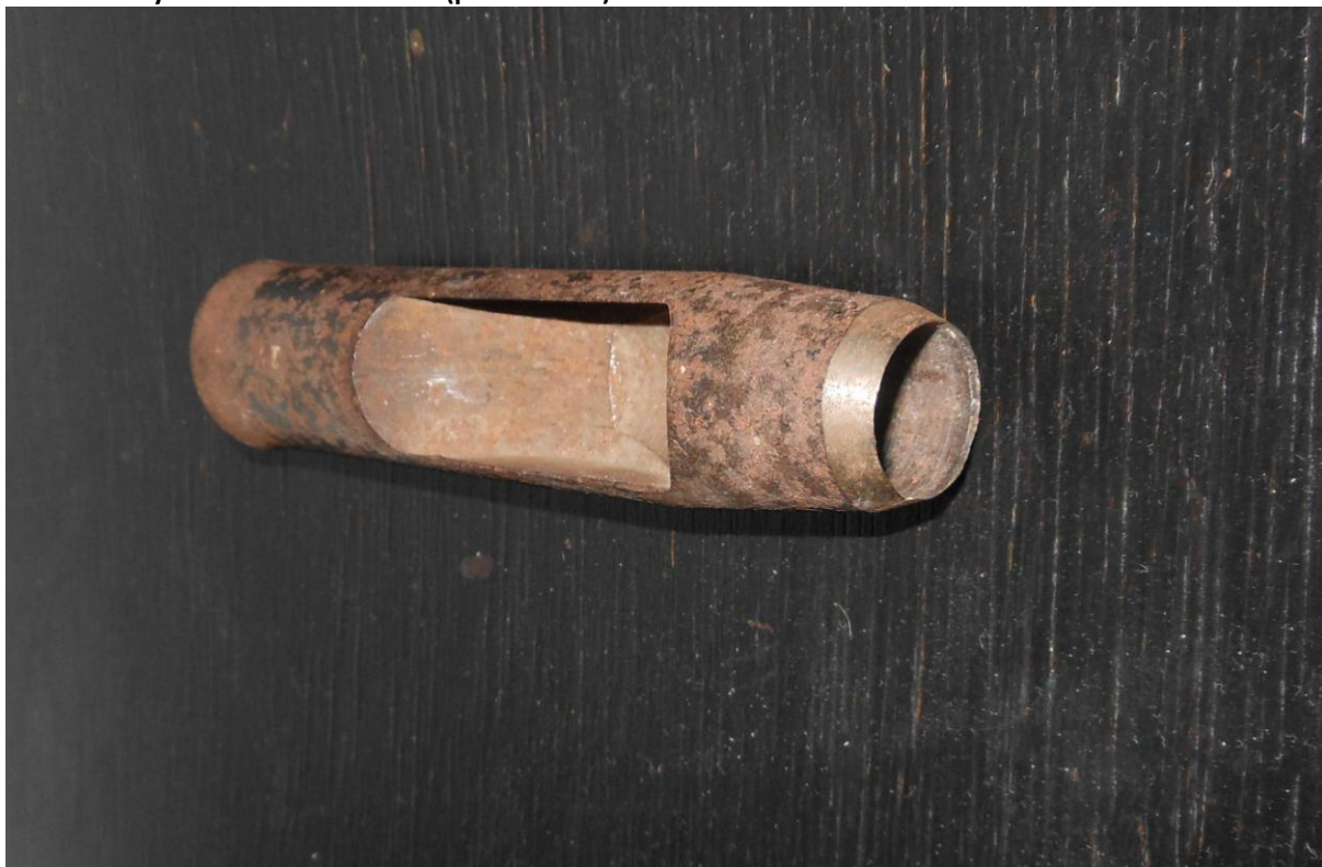
Obrázek 5 Vyrážeč kruhového tvaru (průměr 1cm)
