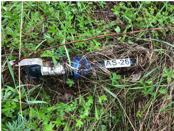
Obr. 7. Aplikační potrubí pro Fentonovo činidlo
