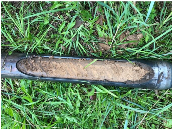
Obr. 13, 14. Svrchní část hloubkového vrtu AS26_s1
