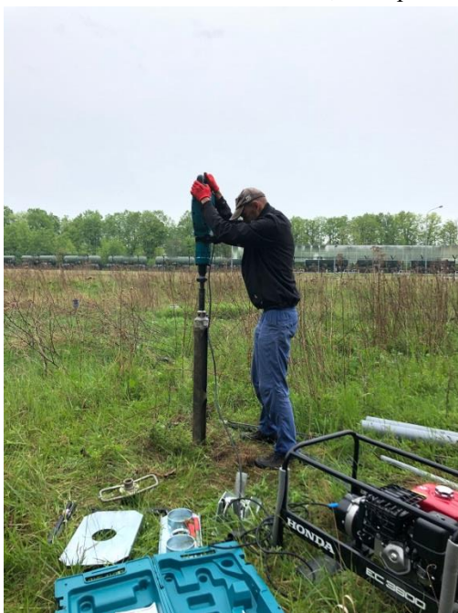
Obr. 11., 12. Vrtná souprava pro odběr vzorků před aplikací remediačních metod
