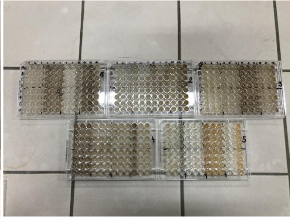
Obr. 19. Aplikační destičky pro stanovení enzymové aktivity
