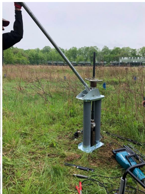
Obr. 11., 12. Vrtná souprava pro odběr vzorků před aplikací remediačních metod
