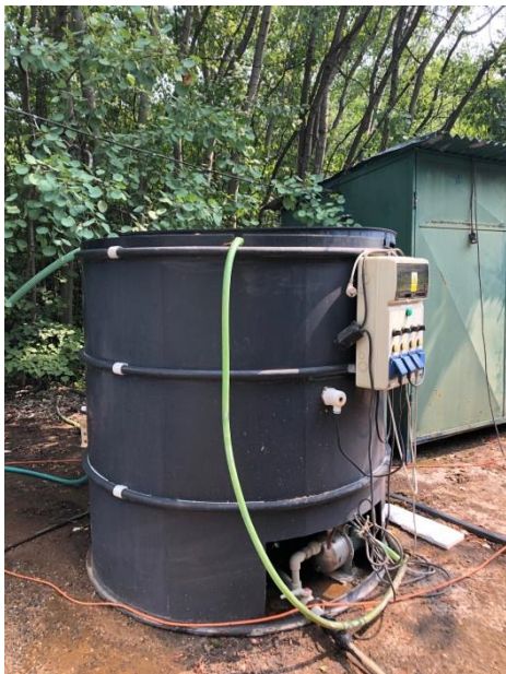
Obr. 7. Aplikační potrubí pro Fentonovo činidlo
