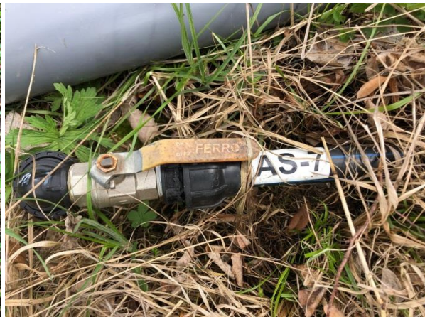
Obr. 8. Aplikační potrubí pro bakterie
