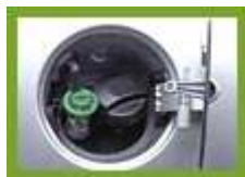
Obr. 11: Na závěr se montuje plnicí koncovka, ta se musí vejít pod víčko palivové nádrže ještě vedle otvoru pro čerpání benzínu.
