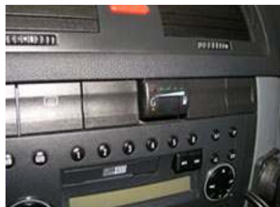
Obr. 18: Přepínač plyn-benzín včetně ukazatele množství paliva
