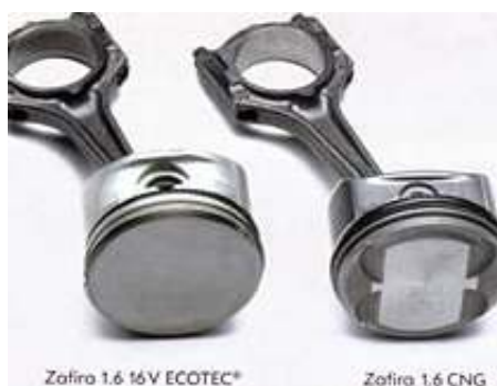
Obr. 6: Porovnání pístů benzínové Opel Zafira 1,6 16V a 1,6 CNG verze
