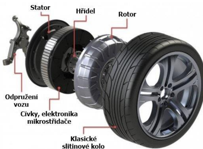
obr. 16 Schéma motoru v kole (Murtinger 2012)
