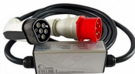
obr. 28 AC přenosná nabíječka CEE 5 kolík 32 A, 22 kW, Mennekes (EVexpert 2018)
