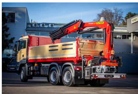
Obrázok 7.7: Valník MAN s hydraulickou rukou Palfinger PK 19.001[19]
