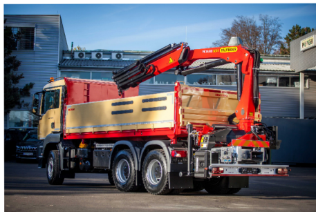
Obrázok 7.7: Valník MAN s hydraulickou rukou Palfinger PK 19.001[19]
