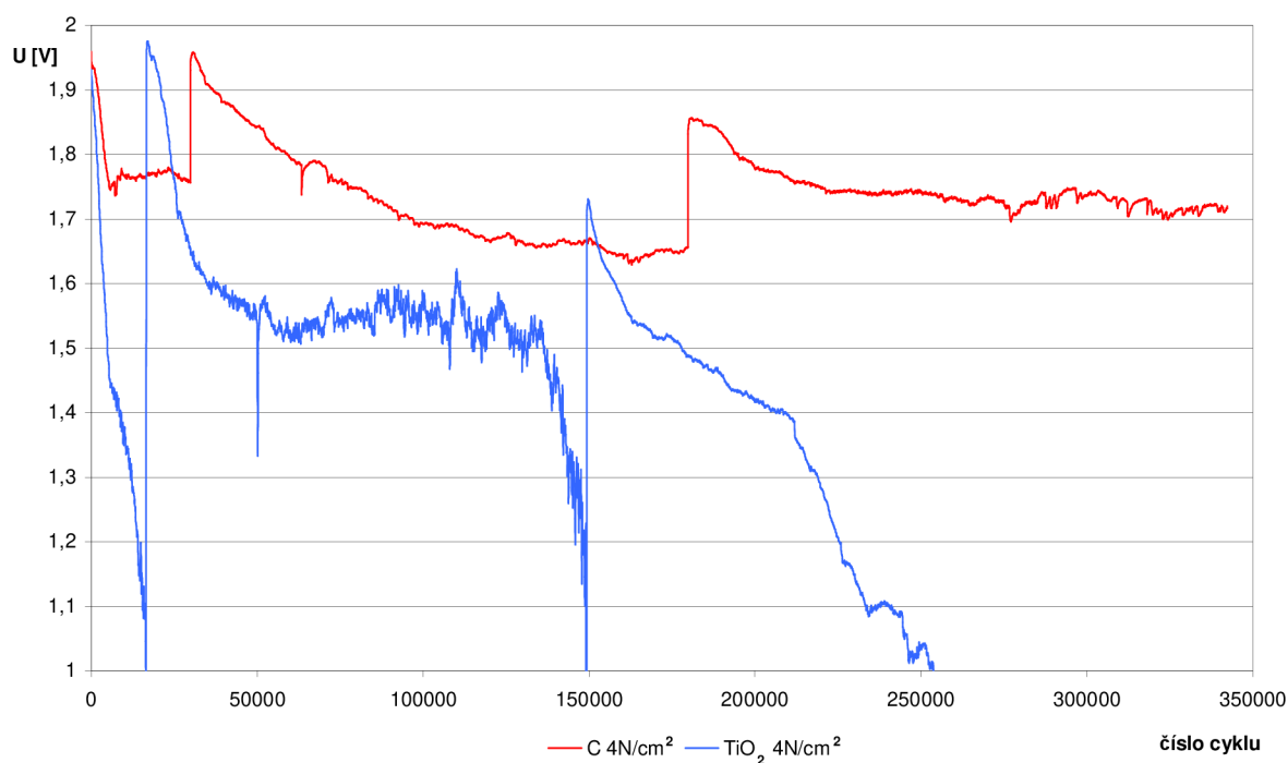
Obr. 35: Všechny tři PSoC běhy, hermetizovaný stav. Závislost napětí při vybíjení na počtu cyklů. Porovnání aditiv C, TiO 2
