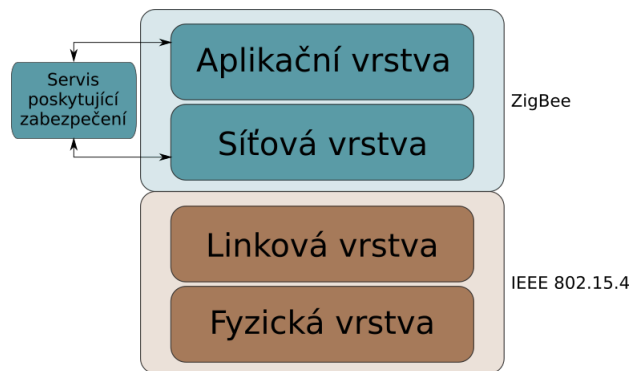
Obr. 1.2: Přehled Zigbee stack architektury (převzato, upraveno [2], str. 25)
