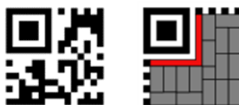
Obrázek 9: Příklad a struktura Micro QR kódu
