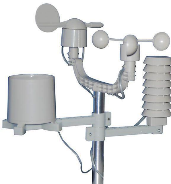
Obrázek 9 - Sestava senzorů pro měření meteorologických veličin
