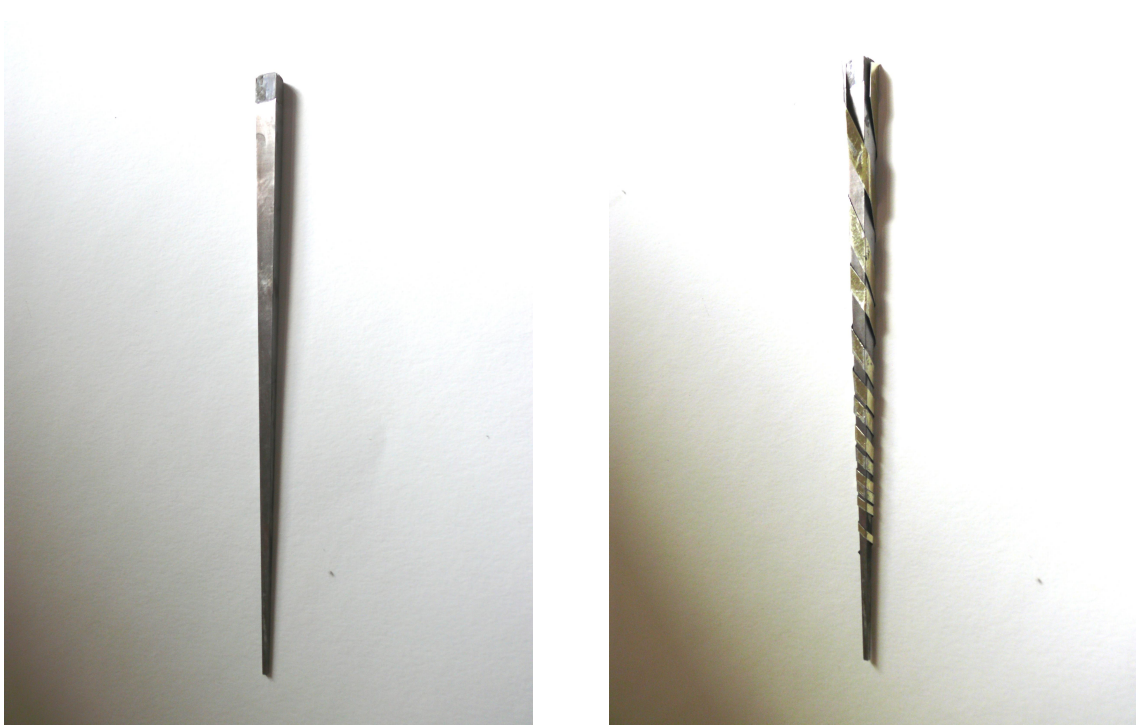
Obr. 16.: ocelový trn k ohýbání Obr. 17.: zroubovice ohýbaná na trnu
