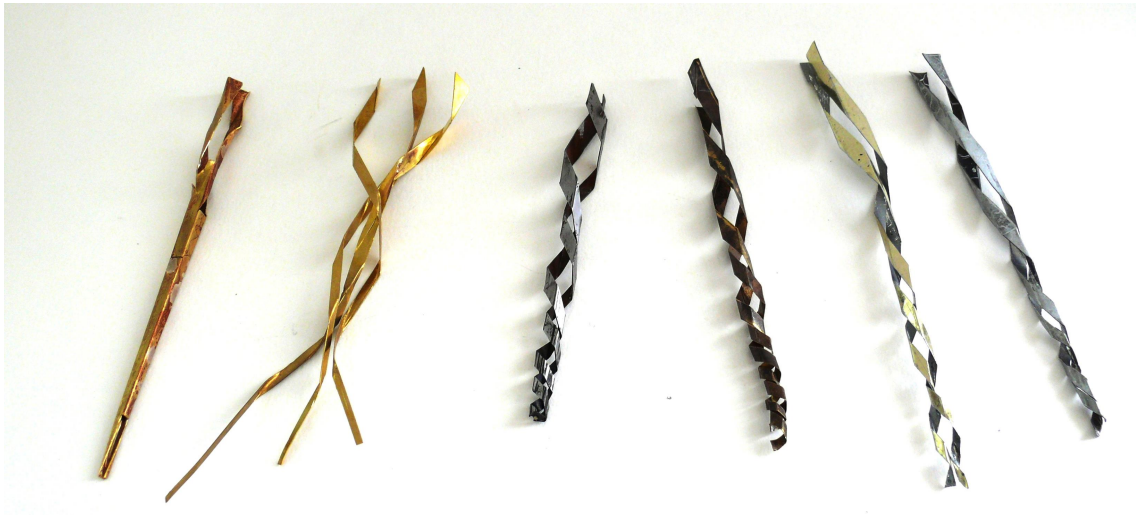
Obr. 15.: Zkoušky jehlic zleva: pro ezávaná dutá jehlice (mosaz); na ezávané a ohýbané jehlice (mosaz); jehlice ohýbaná na trnu 4 x 4/10 x 10 mm (Oelezo); jehlice ohýbaná na trnu 2 x 2/9 x 9 mm se vstupním tvarem kovu lichob Oníku (tombak); jehlice ohýbané na trnu 2 x 2/9 x9 mm s hyperbolickým tvarem kovu (obojí Oelezo)
