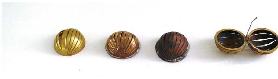
Obr. 17.: Zkoušky proezávanosti mosazných polokoulí
