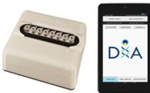
Obr. 36: Přístroj Smart-DART™ umožňuje detekovat najednou až 8 vzorků. (Zdroj: https://images.indiegogo.com/file_attachments/841730/files/20140908013516-Smart-DART_3.0_Platform_Smaller_Promo.png?1410165316 )
