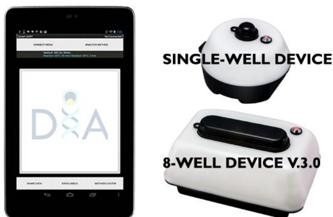
Obr. 35: Přístroj Smart-DART™ určený k polní amplifikaci DNA. Přístroj je ovládán přes bluetooth zařízení pomocí speciální aplikace ve smartphonu nebo tabletu. (Zdroj: http://static1.squarespace.com/static/537ab7efe4b0d683376a1025/t/53a00af3e4b05bbc2dc5f93a/1400808271435/SmartDartPromo08202013.jpg?format=300w )
