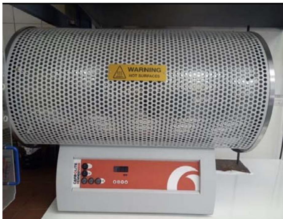
Obrázek 5 Elektrická pec na laboratorní pyrolýzu čistírenského kalu (Mercl et al., 2020).
