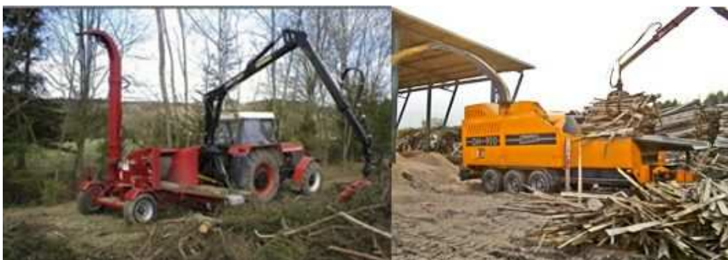
Obrázek 9: Štěpkovač na vlastním přívěsném podvozku, poháněný vývodovým hřídelem traktoru (AMD Maxim 420), štěpkovač s vlastním podvozkem i samostatným pohonem (Doppstadt DH 910) (zdroj: www.biom.cz a www.doppstadt.com )
