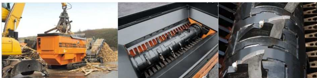
Obrázek 12: Pásový drtič Doppstadt DW 2060 K, drtící ústrojí (zdroj: stránky výrobce)
