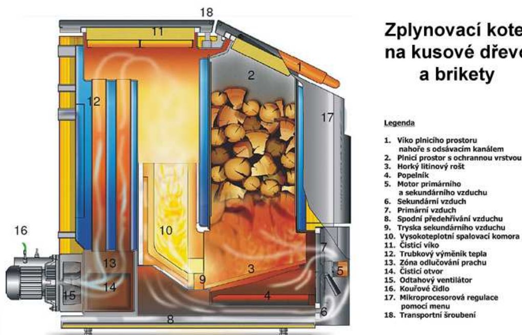
Obrázek 21: Řez zplynovacím kotlem na dřevo Guntamatic Synchro (zdroj obrázku: stránky výrobce)
