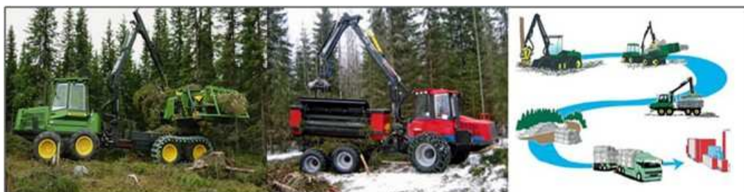
Obrázek 13: Svazkovače John Deere 1490D a Valmet Woodpack, schéma dopravy (zdroj: www.biom.cz )
