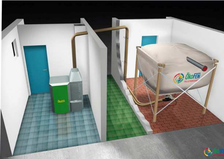
Obrázek 32: Tkaninový zásobník s vakuovým sacím systémem (zdroj: reklamní materiály firmy ÖkoFen)
