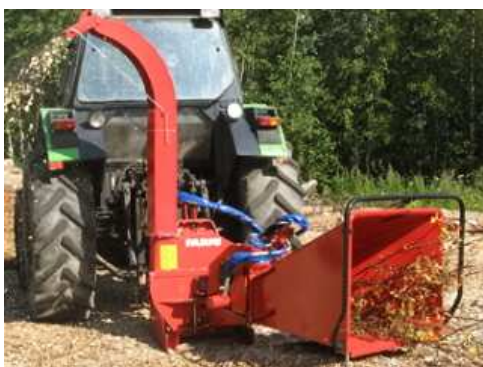
Obrázek 8: Nesený štěpkovač (FARMI CH 180) poháněný traktorem (zdroj: stránky výrobce)
