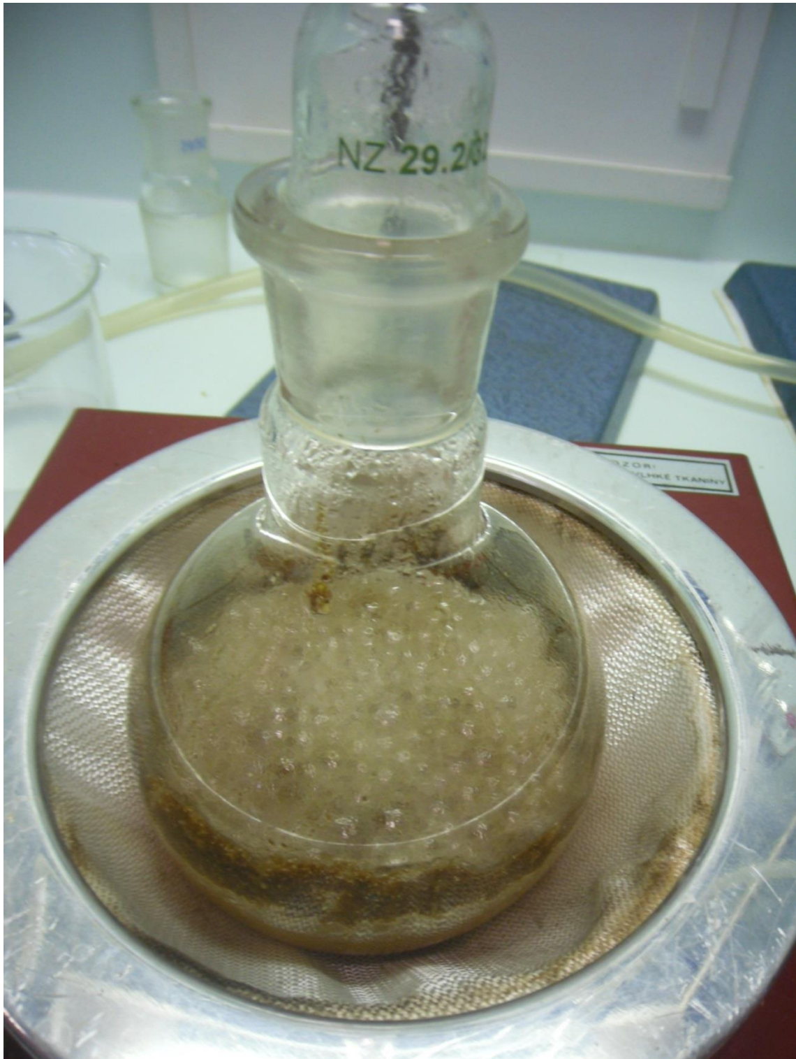
Obrázek 7 Varná baňka s rozemletým vzorkem kmínu a spojená s destilačním přístrojem – průběh vlastní destilace (URBÁNEK, 2014).
