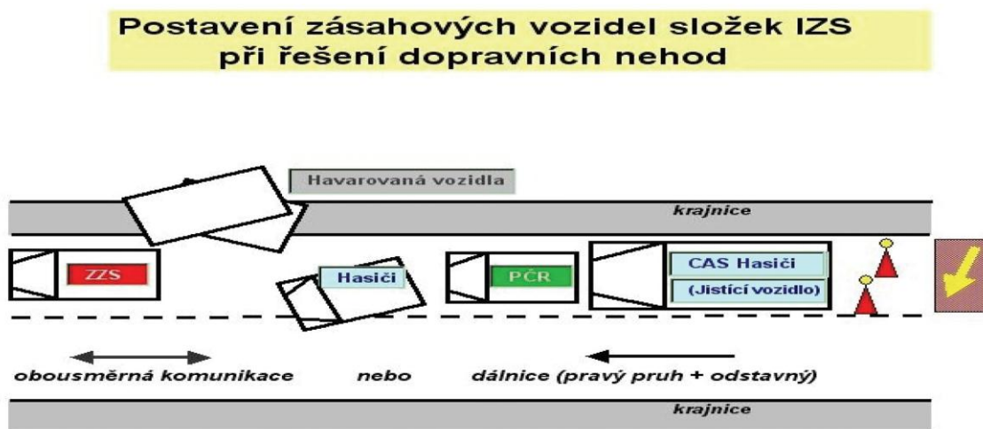
Obrázek 5. První varianta při použití všech dostupných prostředků (mobilní technika složek IZS, výstražné kužele a směrové desky). Zdroj: konspekty odborné přípravy jednotek PO
