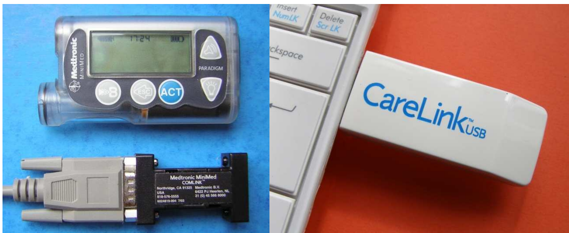
Obrázek 11. Bezdrátový převod dat z inzulínové pumpy do PC pomocí Comlinku (vlevo) a Carelinku USB (vpravo)
