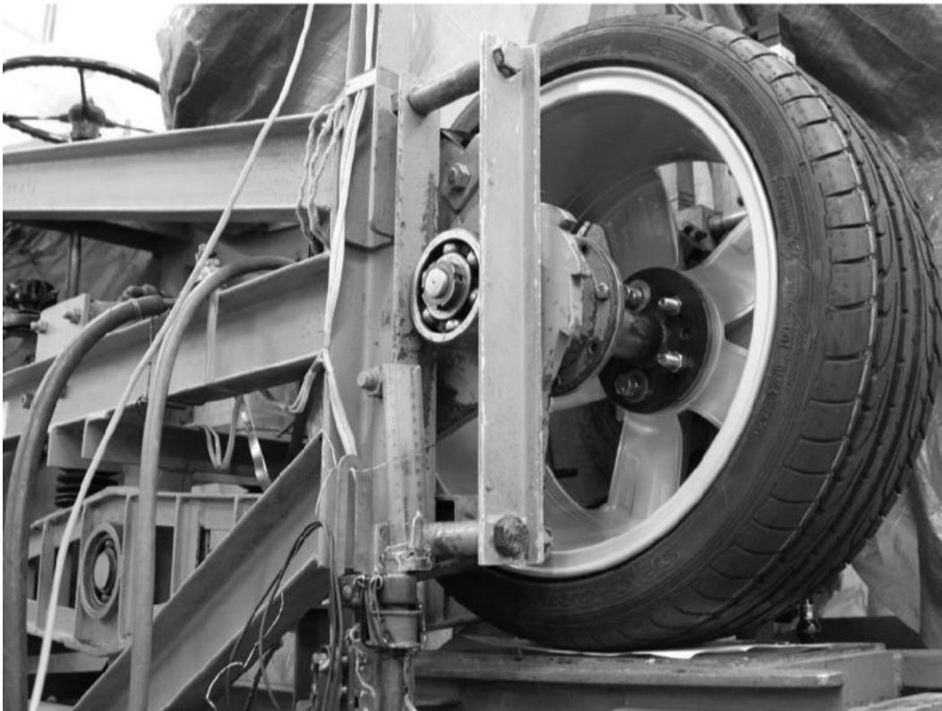
Obrázek 24: Statický adhezor s připravenou pneumatikou pro měření [4]
