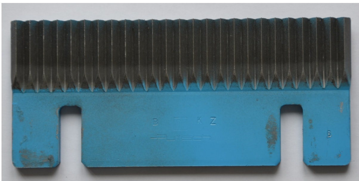
Obr. 6.1 Ukázka značení na noži P - přední strana.
