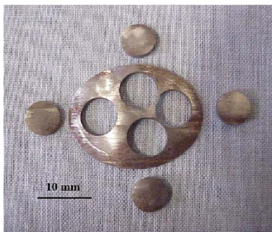
Obr. 6 Vzorky pro penetrační testy odebrané ze zkušebního materiálu [12]
